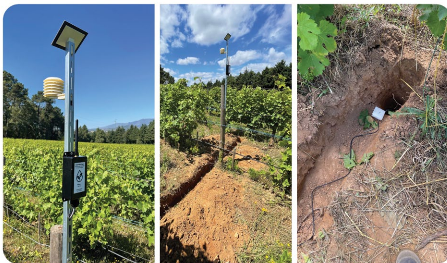
Figura 2. Aquisição de dados numa vinha do Palácio de Mateus no âmbito do projeto PRIMA/DATI (Digital Agriculture Technologies for Irrigation Efficiency), https://datiproject.eu , que visa a recolha de dados para estabelecer melhores estratégias de rega.
