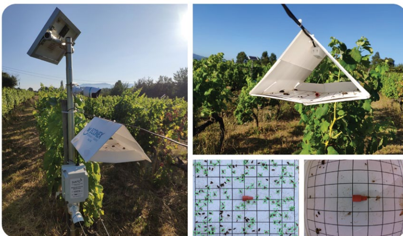
Figura 5. O VineInspector é utilizado para contar insetos (traça da uva), remotamente e em tempo real, e estimar o nível económico de ataque (NEA), fronteira a partir do qual se deve aplicar um tratamento.
