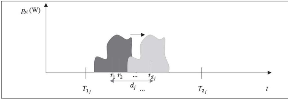
Figura 2. Controlo de cargas deslocáveis, não interrompíveis:  $[T_{1j}, T_{2j}]$  define o intervalo de conforto para o funcionamento da carga  $j$ ,  $d_j$  é a duração do ciclo de operação, e  $r_1, r_2, \dots, r_{d_j}$  são os estádios em que este ciclo é dividido, em cada um dos quais é requerida uma dada potência  $p$ .
