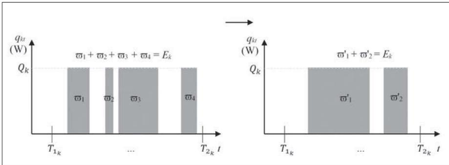
Figura 3. Controlo de cargas interrompíveis:  $[T_{1k}, T_{2k}]$  define o intervalo de conforto para o funcionamento da carga  $k$ ,  $E_k$  é a quantidade de energia que deve ser fornecida e  $Q_k$  é a potência nominal de operação.
