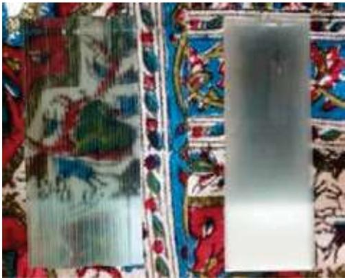
Figura 2. Fotografia de uma toalha de mesa através de uma pilha de lâminas de vidro. À esquerda, com as lâminas de lado, o padrão é perfeitamente visível. À direita, consegue-se ver a imagem da câmara que tira a fotografia.
