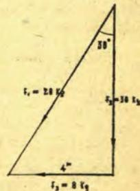
**1245** — Dado o sistema articulado representado na figura, calcular as tensões nas barras *a*, *b* e *c*
