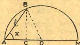
ção de  $l$  e do ângulo  $x = \widehat{BAO}$ , a área do triângulo  $BCO$ . R:  $S = 1/2 \overline{BC} \times \overline{CO} = 1/2 \overline{BC} (r - \overline{AC}) = 1/2 \cdot l \text{sen} x (1/2 \cdot \text{sec} x - l \cos x) = l^2/4 (\text{tg} x - \text{sen} 2x)$ .
