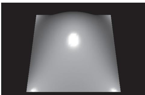
Figura 12. Exemplo de uma superfície B-spline.
