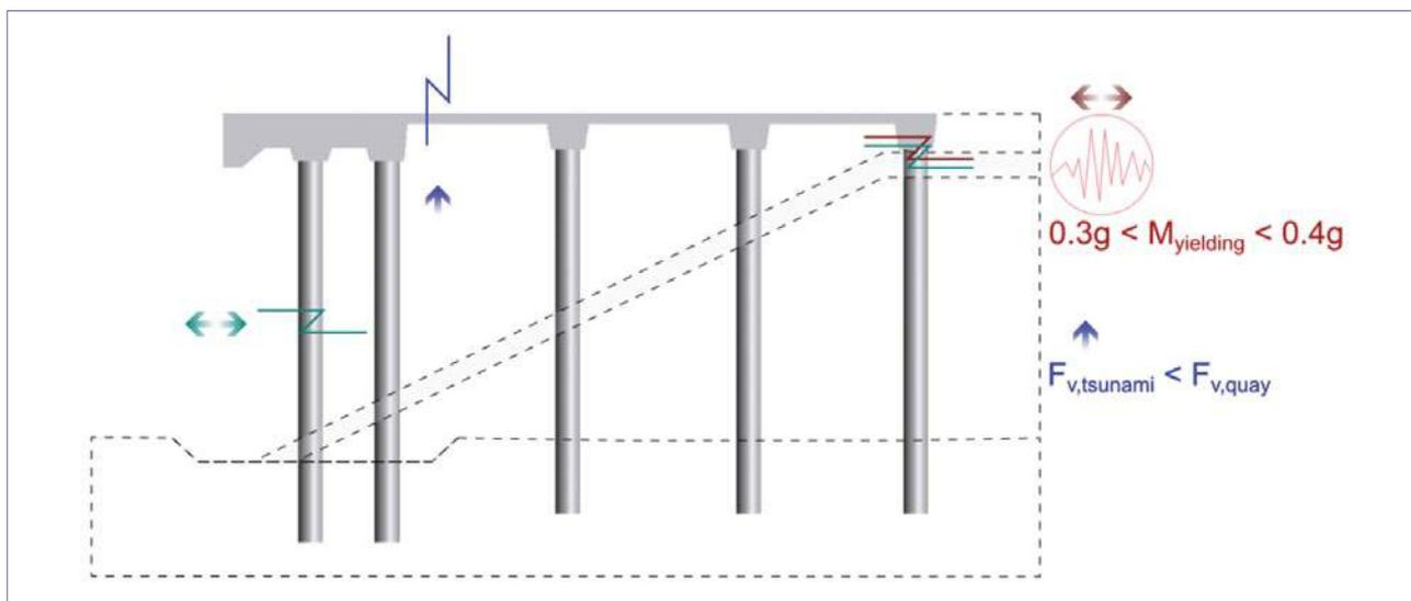
Figura 8. Comportamento sucessivo do sistema geoestrutural ao padrão em cascata de ações de sismo e tsunami.
