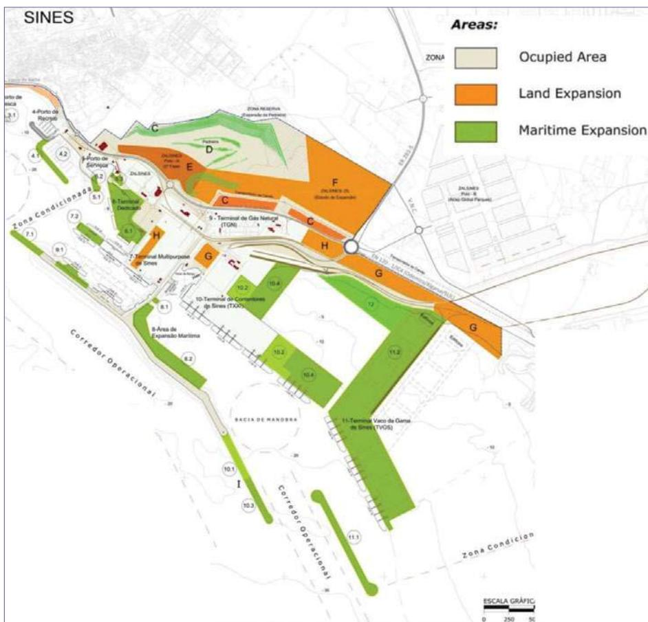
Figura 1. O plano estratégico para aumentar o volume de carga contentorizada movimentada no Porto de Sines prevê: 1) a expansão do terminal de contentores existente, o Terminal XXI, e 2) a construção de um novo terminal de contentores, o Terminal Vasco da Gama.
