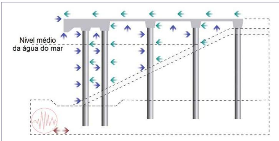
Figura 6. O padrão de cargas em cascata para dimensionamento estrutural engloba a aceleração sísmica aplicada nas fundações seguida pelos efeitos hidráulicos do tsunami nos elementos verticais e horizontais da estrutura, durante as fases de chegada, inundação e recuo das ondas de tsunami.
