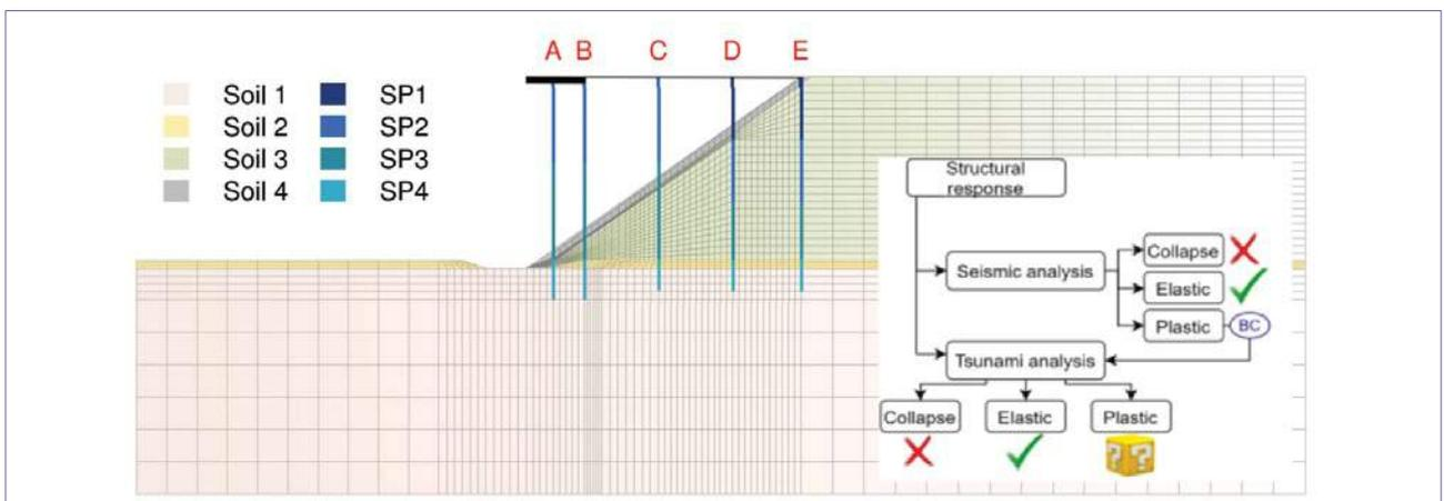
Figura 7. Modelo de discretização usado para prever a resposta sucessiva do sistema geo-estrutural ao padrão de cargas em cascata. O comportamento do sistema pode assumir uma das combinações ilustradas no esquema. As respostas possíveis do sistema são baseadas na comparação entre esforços atuantes.
