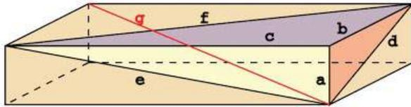
Figura 2. Ilustração<sup>3</sup> de um tijolo com dimensões  $a, b, c$ , diagonais faciais  $d, e, f$ , e diagonal espacial  $g$ .
