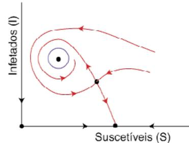
Figura 3. Esquema do diagrama de fase da equação (2.2). Os pontos representam equilíbrios. A curva fechada a azul denota uma solução periódica atratora.
