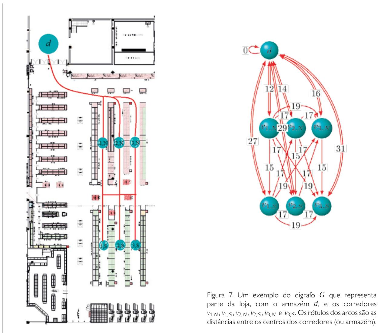
Figura 7. Um exemplo do digrafo  $G$  que representa parte da loja, com o armazém  $d$ , e os corredores  $v_{1,N}$ ,  $v_{1,S}$ ,  $v_{2,N}$ ,  $v_{2,S}$ ,  $v_{3,N}$  e  $v_{3,S}$ . Os rótulos dos arcos são as distâncias entre os centros dos corredores (ou armazém).
