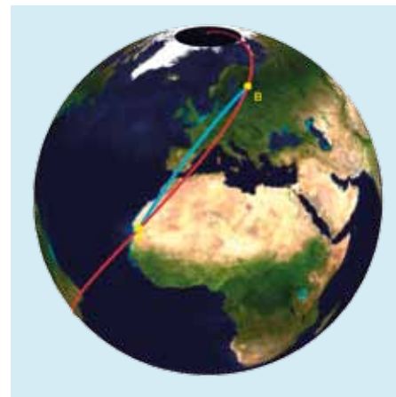
Figura 4: A vermelho é apresentada uma loxodrômica, cujo traço tem a forma de espiral. A azul assinala-se o caminho mais curto na esfera entre dois pontos da loxodrômica.
