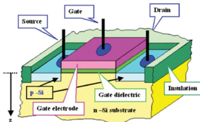
Figura 1. Esquema do dispositivo semicondutor de óxido de metal.
