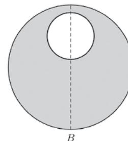
Figura 2. Construção de sempre-em-pé com material homogéneo.
